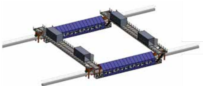
Specialdesignet adgangsenhed for hængesbro vedligehold (R&D, Ålsrode Smede og Maskinfabrik & Davai Design)
