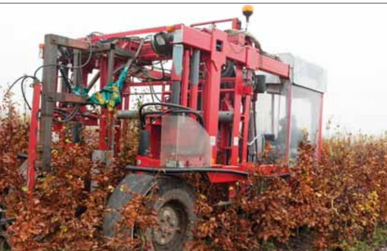
Maskinen, som er én af mange, har Lars og hans dygtige medarbejdere selv opfundet, konstrueret og bygget. Maskinen aflæser og beregner hver enkelt plantes position
