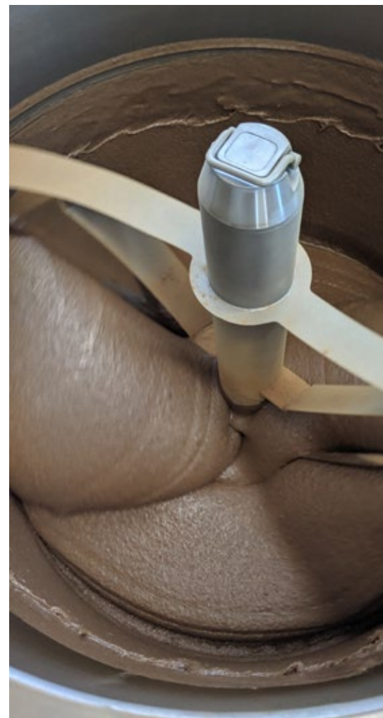
Induktionskipgryden skal kunne varme op til over 150 grader, have præcis temperaturstyring hurtig og effektiv regulering af temperaturen.
