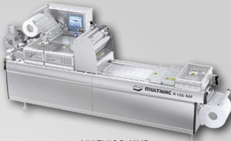
MULTIVAC R105MF Pakkemaskine til vakuum,- MAP og skinpakning
