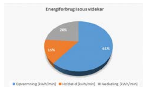
Figur 1. Energiforbrug per minut ved sous vide-tilberedning i sous vide-kar og i industriovn
