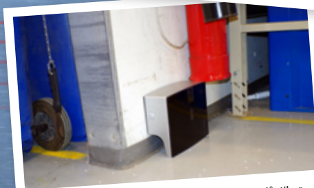
Sensorer registrerer skadedyret i fælden, en slagarm slår til og brækker nakken på det.
