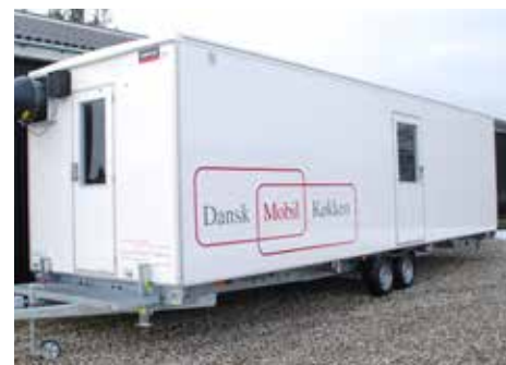
De mobile køkkenalvogne er op til 9 m lange. Under vognen er der klargjort til brug af varmt/koldt vand og kloak.
