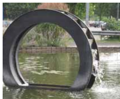
Ilttilførsel forbedrer forholdene i de mest krævende miljøer. Her er det en offentlig dam, hvor der er placeret et vandhjul til at cirkulere vandet.
