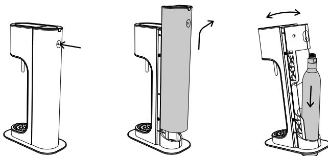
Käännä hiilihapotuslaitetta eteenpäin ja työnä hiilidioksidipullo laitteen pohjassa olevaan aukkoon siten, että hiilidioksidipallon jää seisomaan alustalle. Käännä sitten hiilihapotuslaitetta takaisin taaksepäin siten, että laite nojaa hiilidioksidipullen kierteisiin.
