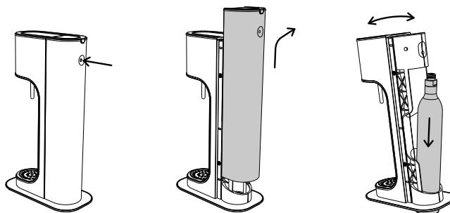
Vinkla kolsyremaskinen framåt och för ner kolsyreflaskan genom öppningen i botten av maskinen, så att kolsyreflaskan står på underlaget. Vinkla sedan tillbaka kolsyremaskinen så att ovandelen av maskinen lutar mot kolsyreflaskans gänga.
