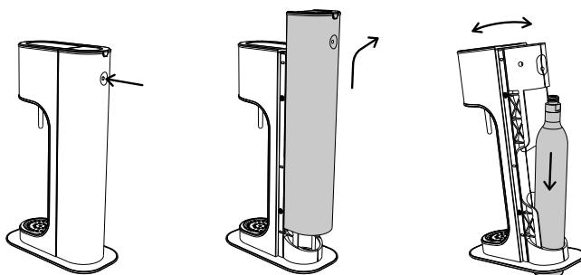
Vipp kullsyrermaskinen fremover og før gassflasken ned gjennom åpningen i bunnen av maskinen, slik at gassflasken står på underlaget. Deretter vipper du kullsyrermaskinen tilbake, slik at overdelen av maskinen heller mot gassflaskens gjenger.
