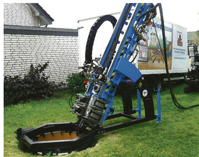
Ny teknologi gør det muligt at etablere anlæg til jordvarme på mindre arealer. Clevertec fra Frederikssund er i førerfeltet med den nye teknik.
