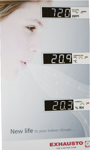
Der er opsat en indeklima-logger fra Exhausto for at kunne foretage en indeklimaevaluering før og efter installationen af det nye ventilationssystem. Der måles for temperatur, luftfugtighed og CO 2
