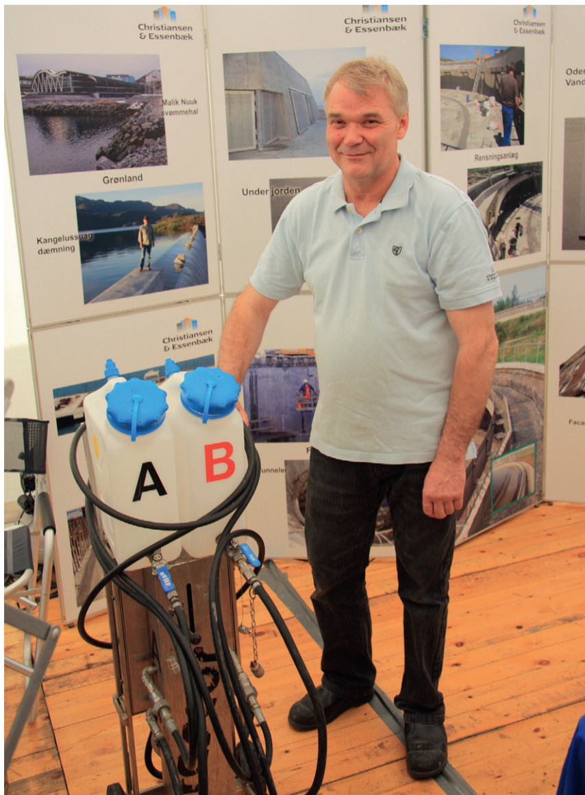
Leif Næsgaard, Injeceringsoperatør, viser her det værktøj, der bruges til at indsprøjte injiceringsvæske
